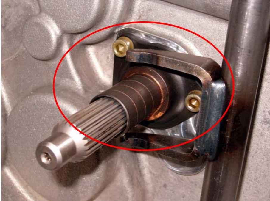
Nous vous rappelons qu'il est important d'appliquer de la graisse cuivre (généreusement) sur le guide butée, ainsi que sur l'alésage de la butée, et de faire fonctionner l'ensemble « fourchette / butée » trois ou quatre fois avant d'assembler la boîte sur le moteur.
