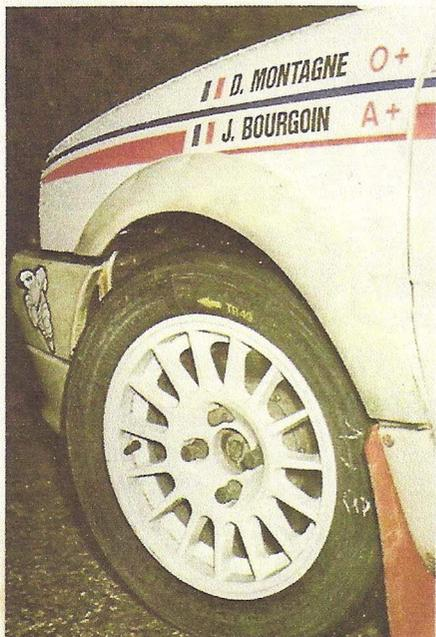
Sur la terre et le goudron, l'AX Sport garde un diamètre de roue de 14 pouces.
